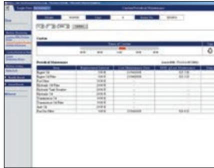
**Planificación de mantenimiento** – Para aumentar la productividad y mejorar la planificación de mantenimiento, las alertas indican cuándo se deben cambiar elementos como los filtros o el aceite.
