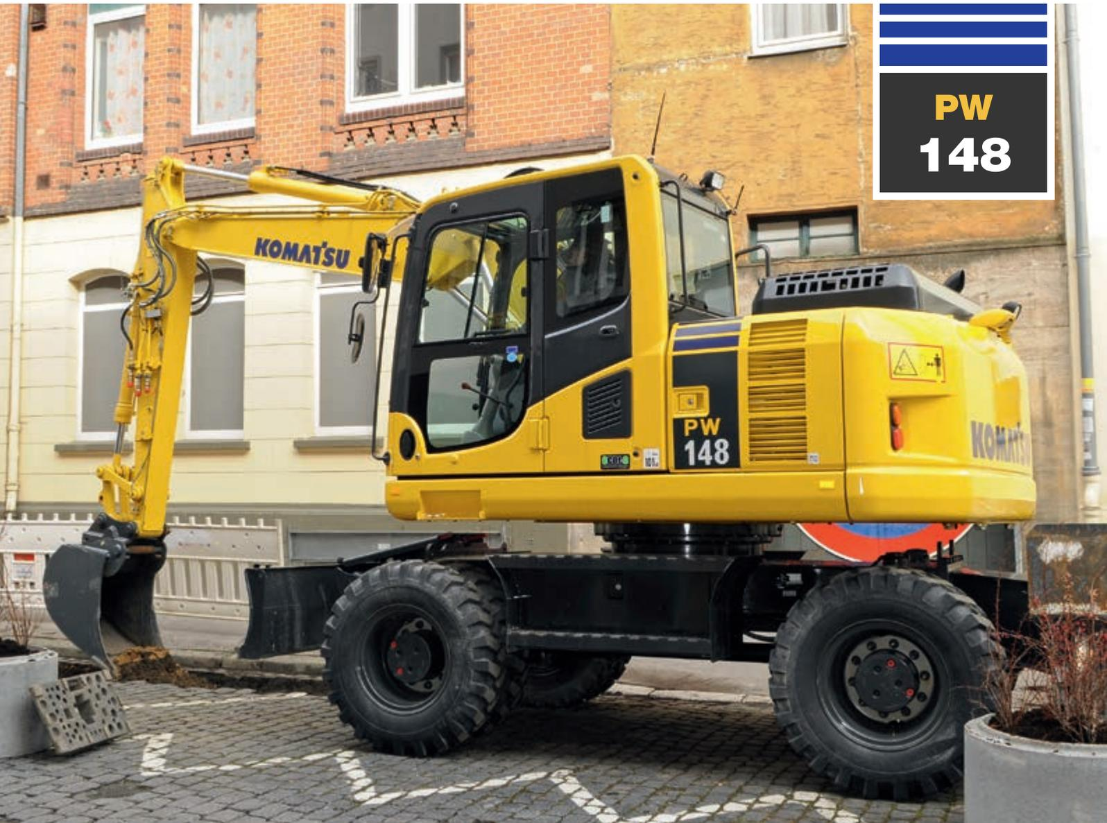
Excavadora hidráulica sobre ruedas
