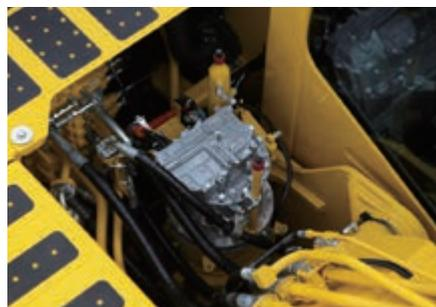
**Motor-generator de rotación eléctrica**
