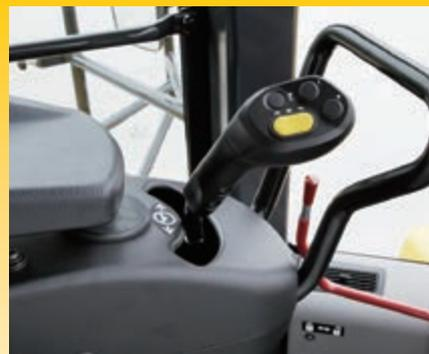
Advanced Joystick Steering System (sistema de dirección avanzado por joystick)
