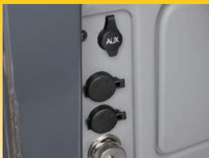
Entrada auxiliar (clavija MP3) y 2 puertos de 12 voltios
